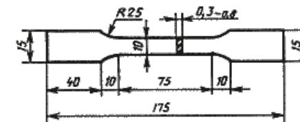
Для испытания на растяжение от каждого контролируемого листа вырезают один образец поперек направления прокатки.
